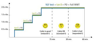
aislamiento del cable y, con la ayuda de una medición de descargas parciales, permite visualizar y localizar con exactitud los puntos de avería DP. Lo mejor del MWT es la posibilidad de ajustar la duración del ensayo al estado del cable: siempre que sea admisible, la duración del ensayo se puede acortar para reducir así los costes. Gracias a ello, el cable no queda expuesto más tiempo del necesario al aumento de tensión aplicado durante el ensayo.
