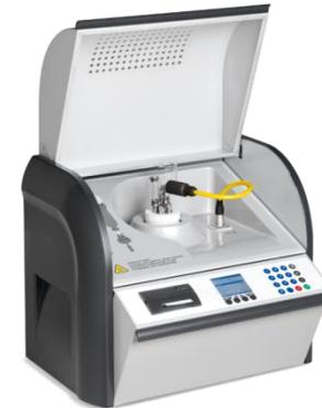
Medición del factor de disipación hasta  $1 \times 10^{-6}$ , de la resistencia específica hasta 100 000 ohmios y de la constante dieléctrica. Realizada de forma totalmente automática y de acuerdo con las normas.
