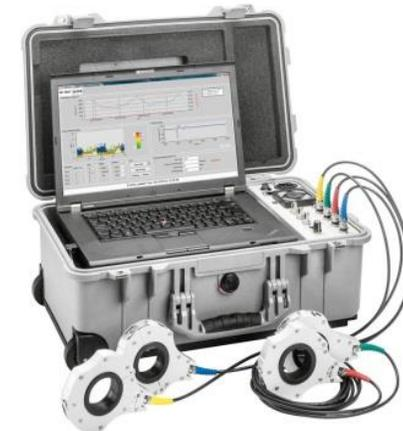
Control periódico en línea de las descargas parciales en cables de media tensión
