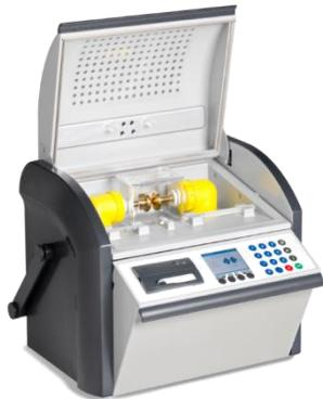
Medición de la rigidez dieléctrica de los aceites aislantes hasta 75 kV. Realizada de forma totalmente automática y de acuerdo con las normas.
