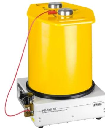
Equipo móvil para medir simultáneamente las descargas parciales y el valor tan delta
