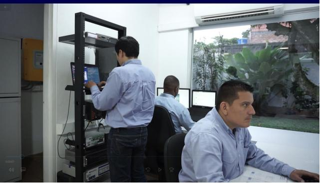
Las pruebas HIL (Hardware-In-the-Loop) son simulaciones en tiempo real que permiten validar y verificar el rendimiento de los sistemas implementados, utilizando un entorno virtual controlado para probar y mejorar la funcionalidad antes de su implementación en campo.
